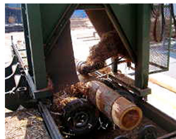
丸太も元と末によって太さが違ったり、飛び出した節や曲りもあるので、バーカーをうまく操作して皮だけをむいていくようにするのは、慣れないと意外と難しい作業です。
