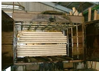
弊社で使用している低温除湿乾燥機のひとつ。これは4mまでの柱や土台などの角類専用。1mから8mの材まで乾燥可能です。
