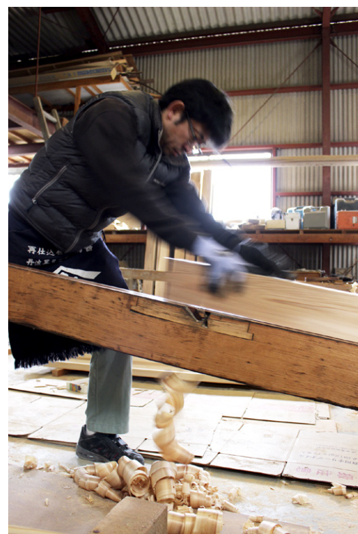
左：台鉋で押し切りをして、桶の丸みを作る。右上：吉野の弊社工場に材料を確認にしに来られた時の様子。右下：桶の底板を切断中。
