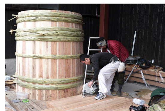
左：台鉋で押し切りをして、桶の丸みを作る。右上：吉野の弊社工場に材料を確認にしに来られた時の様子。右下：桶の底板を切断中。
