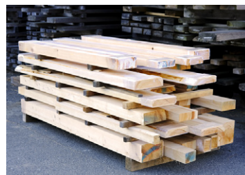
棧積みで自然乾燥している様子。板材、梁材等、乾燥する材に応じて棧を使い分け、一段ごときっちり計って棧を入れてあります。
