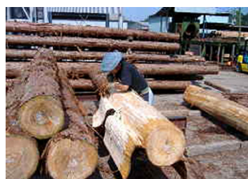
皮むきに使う道具はたった2つ、左下のカマと左上のヘラです。カマを使い1m間隔で縦に区切りをつけ、ヘラで皮をむきます。軽トラ一杯分の桧皮を取るのに約100本の原木が必要です。
