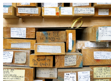
注文時の適切な材選別を行うために、一次製材後、材の情報を詳しく1本1本に表示し、在庫しておきます。
