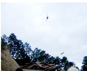
ヘリコプターのすごいパワー。約1t弱の荷物を吊り上げて、輸送できます。
